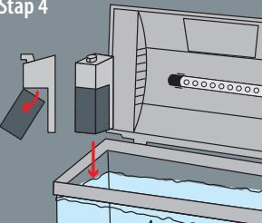
Lees eerst de Aqua-Flow gebruiksaanwijzing. Installeer het AquaFlow filter in het aquarium. Het filter zorgt ervoor dat het water gezond blijft, daarvoor moet de filtercassette wel wekelijks schoongespoeld worden. Klik de cassette van het filter en spoel deze af met schoon kraanwater. De cassette bevat kool wat schadelijke stoffen uit het water absorbeert, vervang de cassette maandelijks voor een goede werking.
